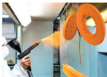
PINTURA utiliza pó em superfícies carregadas eletricamente
